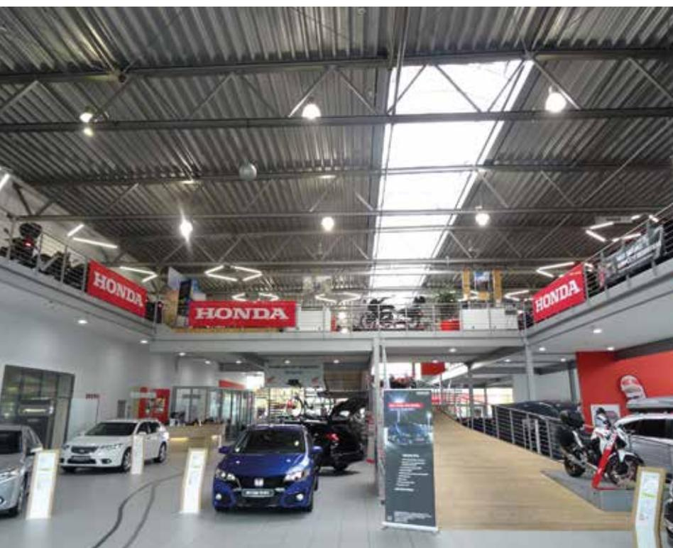
In vielen Autohäusern sind noch Gasdampflampen mit beispielsweise 400 Watt + 80 Watt Vorschaltgerät im Einsatz. Mit einer Umstellung auf LED kann hier die Beleuchtung mit 1 x 120 Watt Ledlight HQL-Ersatz realisiert werden, was zusätzlich zur enormen Energieersparnis auch noch zu einer Lichtverbesserung führt, generiert durch eine höhere Lichtausbeute und die wesentlich bessere Farbwiedergabe.
